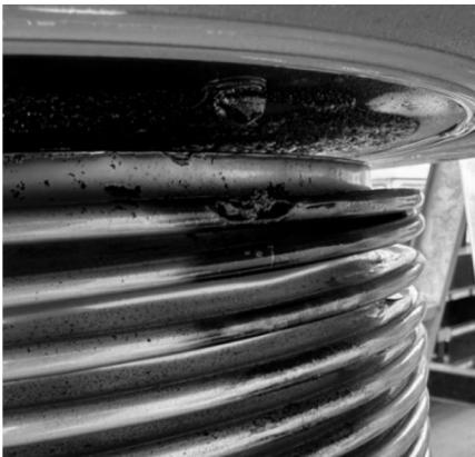
图 11 扩张器击穿孔 Fig. 11 Expander punch
